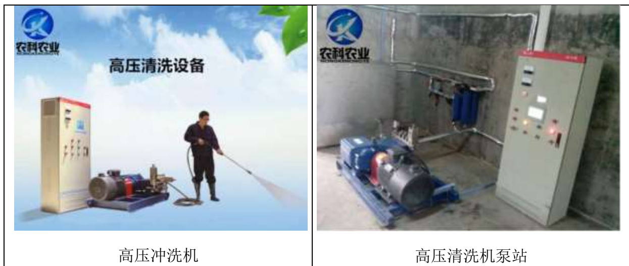
图 3.3-3 高压清洗设备
