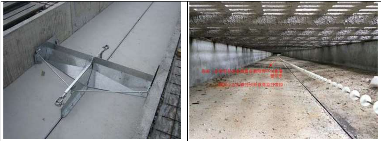
图 3.3-2 机械刮粪机及漏缝地板结构示意图
