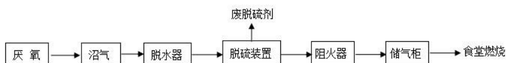
图 5-1 沼气利用主要工艺流程图
